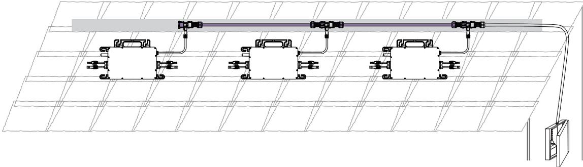
**Die AC-Ausgangsleitung besteht aus fünf Hauptkomponenten: Endkappe, Trunk-Verbinder, weiblicher Verbinder, männlicher Verbinder und Verbindungskabel.**
